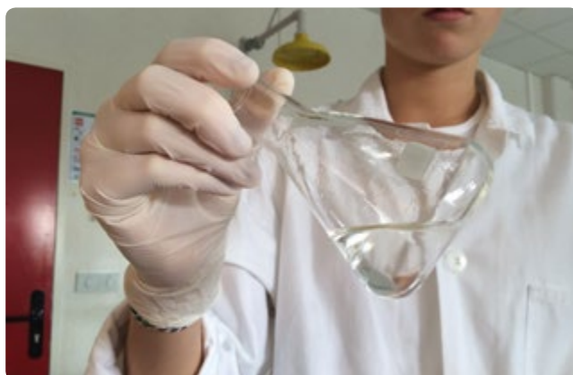
RYS. 4 Suszenie fazy organicznej przy użyciu środka suszącego
