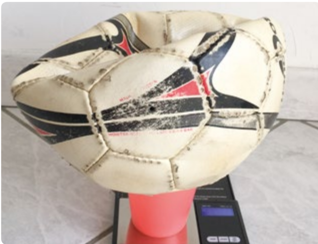
RYS. 4 Pomiar masy pustej piłki
