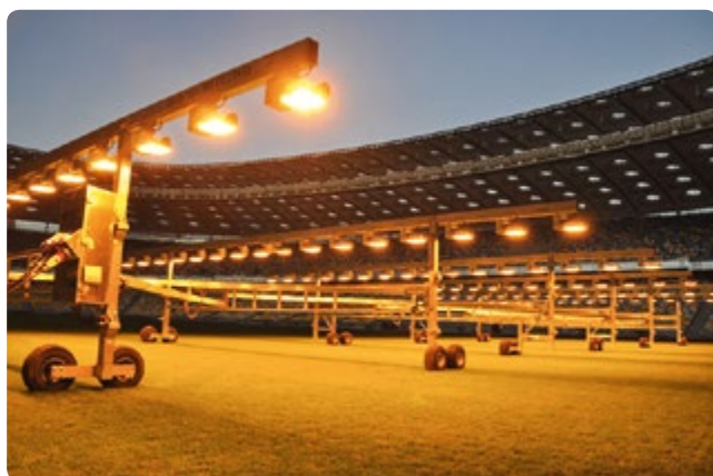
RYS. 1 Instalacje oświetleniowe przyspieszające wzrost trawy
